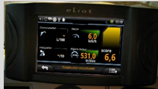
« Module d'éco-conduite » sur les dalles tactiles dans les véhicules
